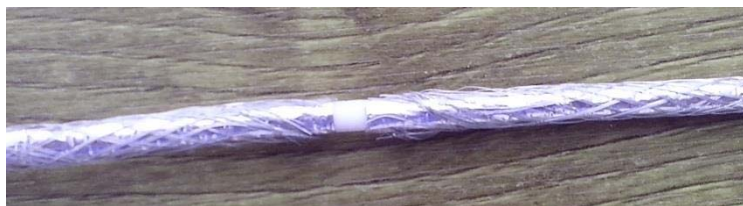
obr. 19: Obnažená část stínění
